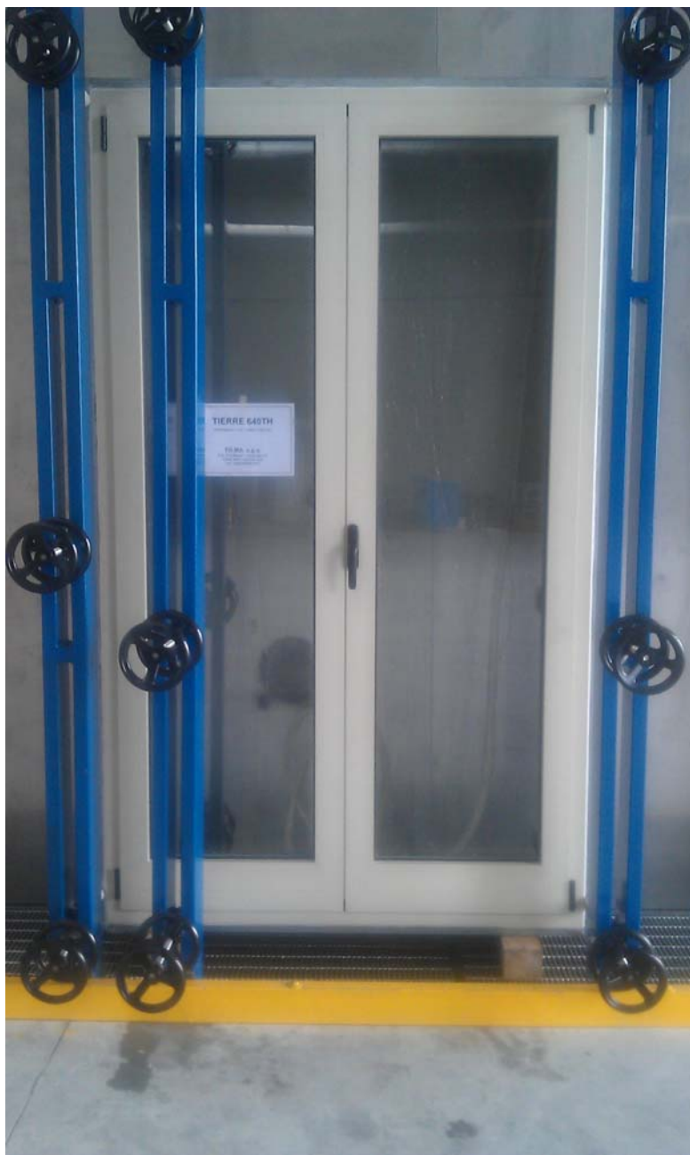
Foto 2: Campione durante la prova di tenuta all'acqua
