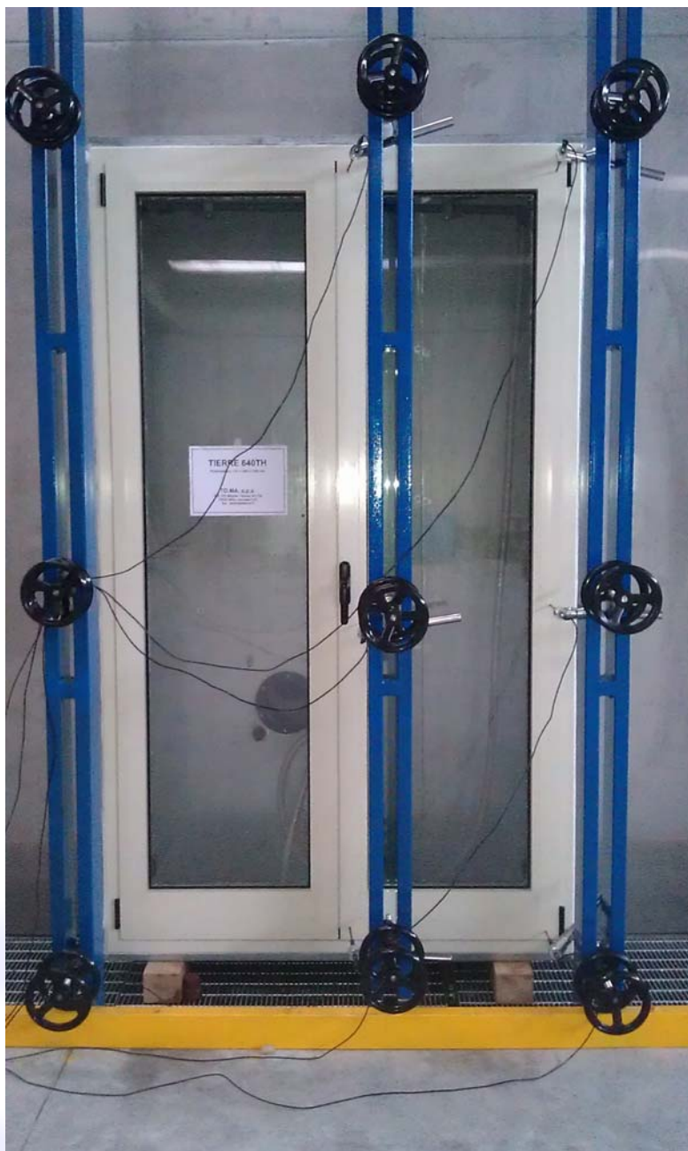
Foto 3: Campione durante la prova di resistenza al carico del vento (prova di deformazione)
